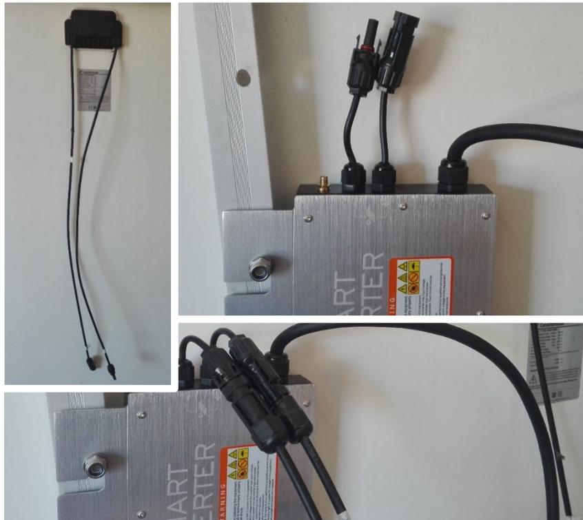
Abbildung 2: Oben links Anschlusskabel am Modul (0,9 m); oben rechts Wechselrichter befestigt auf der Rückseite des Moduls mit den MC4 Steckern für ein Modul; Bild unten Kabel des Moduls angeschlossen an den Wechselrichter.
